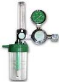
Manómetro, caudalímetro y humidificador.
